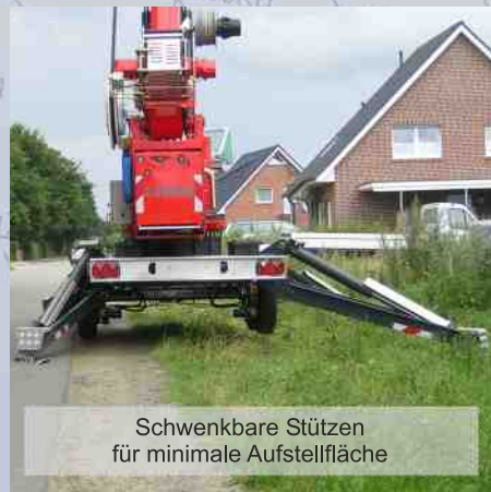
Variable Klappstützen gewähren große Bodenfreiheit bei höchstmöglicher Sicherheit
