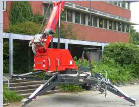
Variable Klappstützen gewähren große Bodenfreiheit bei höchstmöglicher Sicherheit
